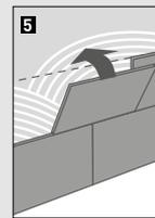
pistolet à mastic sur l'arrière de la dalle tout autour et au milieu comme le montre la figure 4. Maintenir pendant 5 secondes après la pose. Prenez un nettoyeur à côté en cas de taches. Commencer en bas de droite à gauche avec la rainure au-dessus. Ensuite vient s'emboîter le tenon. Avec un
